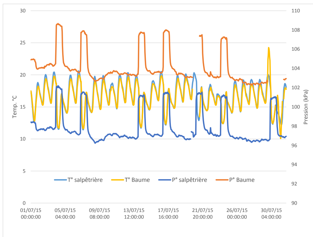
Figure 13 : Evolution des pressions (proxy du débit) et températures de l'eau enregistrées sur les deux stations au mois de juillet 2015 (les valeurs brutes de pression diffèrent car la profondeur de pose est différente entre les deux stations)
