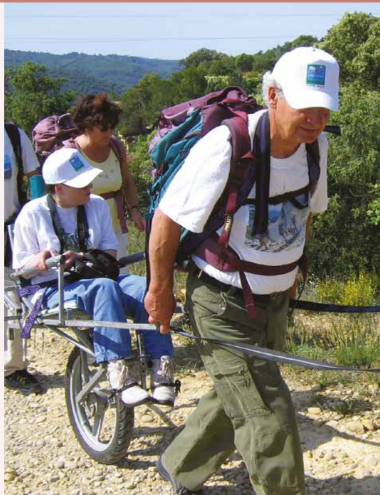
La « Joëlette », fauteuil à une seule roue, permet d'emmener une personne à mobilité réduite sur la plupart des sentiers.
