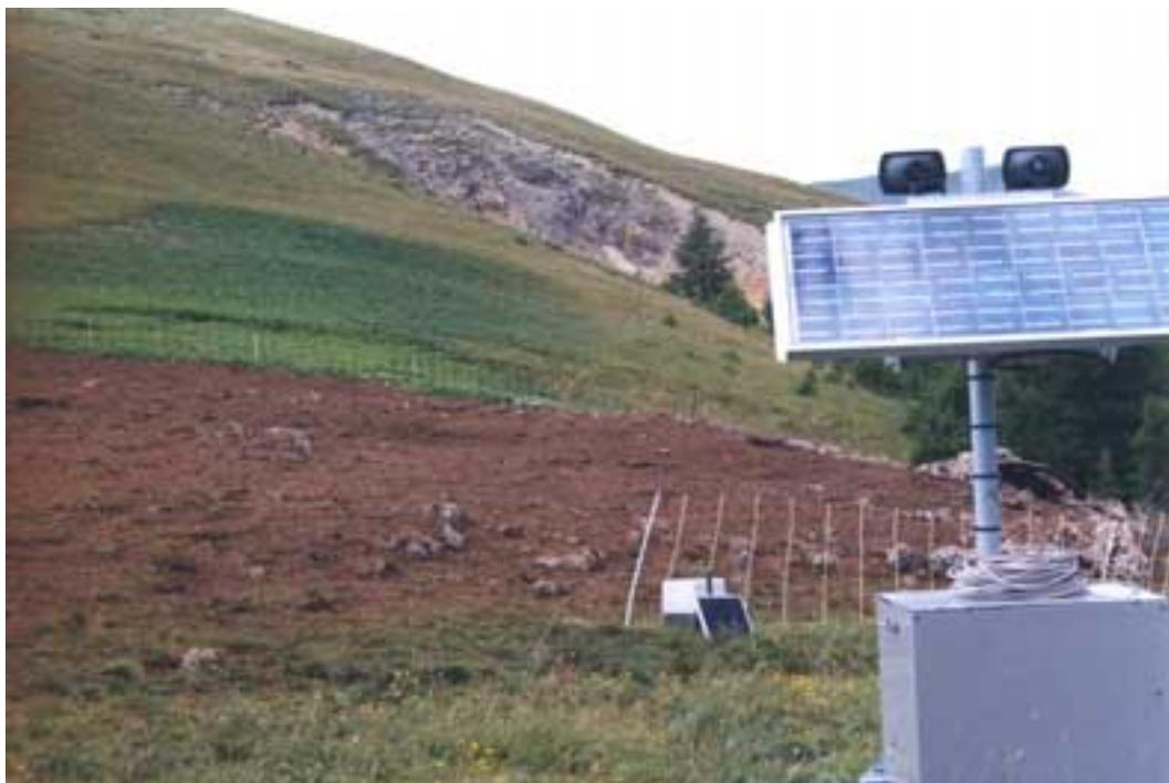
**Système expérimental à balises lumineuses et alarme installé autour d'un parc de regroupement sur un alpage du Mercantour**
