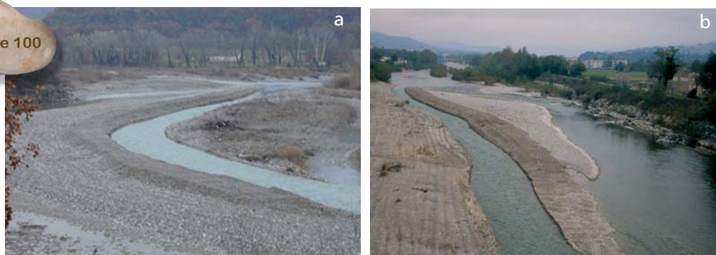
Tranchées réalisées sur la Drôme sur des tronçons à méandre libre (a) (1997) et contraint par des digues (b) (2003).
