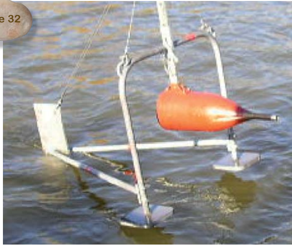
Bouteille de Delft sur chariot pour la mesure du transport solide à proximité du fond.
