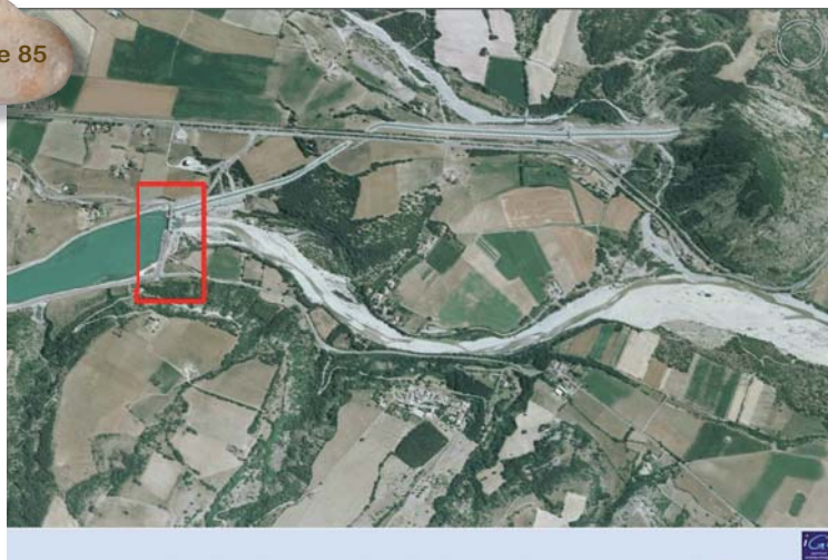
Barrage piégeant probablement une partie de la charge de fond mais n'ayant pas d'effet visible (à vérifier par des analyses plus poussées du profil en long) sur la réduction des apports en aval (existence d'ouvrages de dégrèvement fonctionnels ?).
