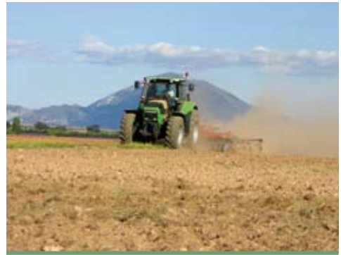
Photo 16 : L'entretien mécanique par disques laisse le sol entièrement nu.
